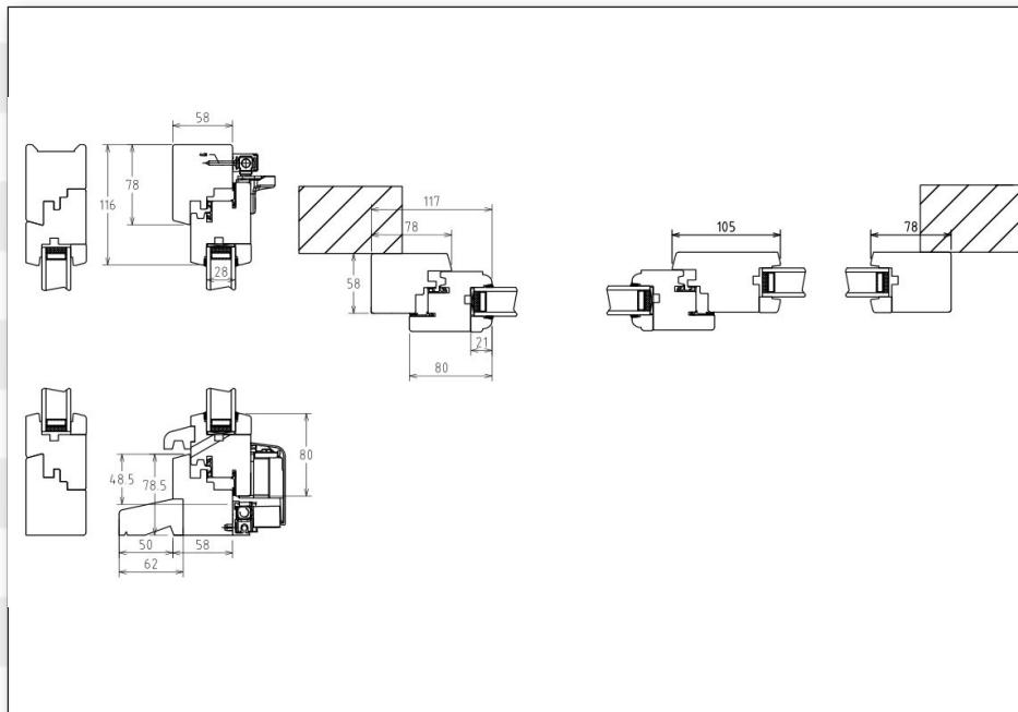
Fenêtre coulissante à translation à 1 Vtl et un fixe, 58mm, double joint, profil pente 15°.
