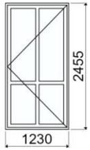
Portes isolantes équipées de paumelles réglables, d'un seuil aluminium surbaissé ou d'une plinthe automatique encastrée
