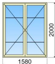
Menuiseries isolantes gamme EURO avec recouvrement (jeu de 12 mm), pièce d'appui et jet d'eau arrondis, portes fenêtre équipées d'un seuil aluminium surbaissé.
