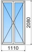
Menuiseries isolantes gamme Auvergne avec recouvrement (jeu de 4 mm), pièce d'appui et jet d'eau arrondis, portes fenêtre équipées d'un seuil aluminium surbaissé
