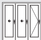
Schéma 330 2 vantaux pliants-couissants 1 vantail ouvrant à la française
