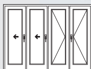
Schéma 431 [1] 2 vantaux pliants-couissants 1 vantail semi-fixe, 1 vantail ouvrant à la française
