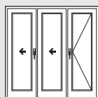
Schéma 321 [1] 2 vantaux pliants-couissants 1 vantail ouvrant à la française
