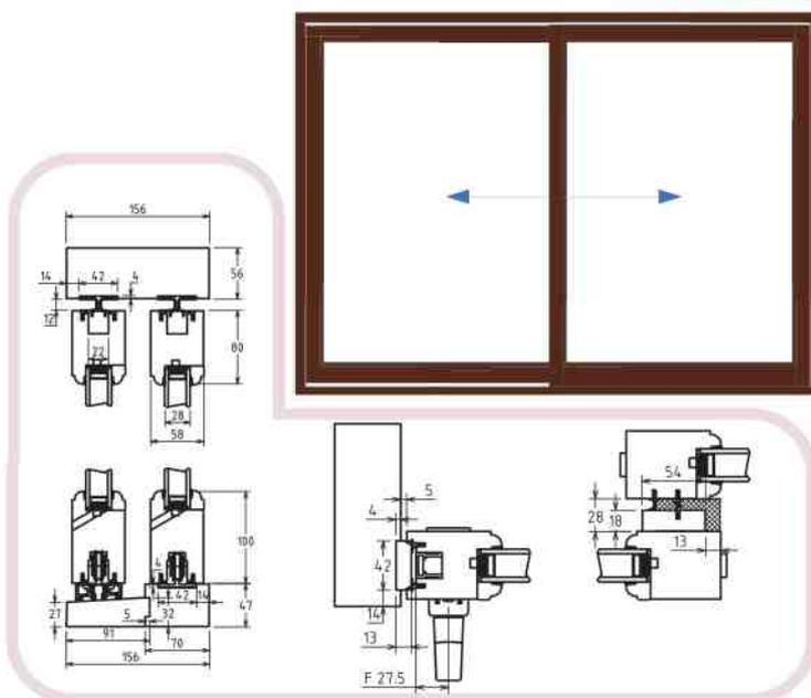
Fermeture soulevante-coulissante – Disposition des vantaux suivants schémas A à L.
