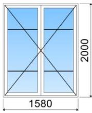
*Menuiseries isolantes gamme « EURO » avec recouvrement (jeu de 12 mm), pièce d'appui et jet d'eau arrondis, portes fenêtre équipées d'un seuil aluminium surbaissé.
