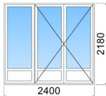
Menuiseries isolantes gamme « EURO » avec recouvrement (jeu de 12 mm), pièce d'appui et jet d'eau arrondis, portes fenêtre équipées d'un seuil aluminium surbaissé.
