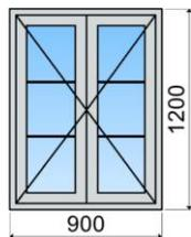
Menuiseries isolantes gamme « EURO » avec recouvrement, pièce d'appui et jet d'eau arrondis, portes fenêtre équipées d'un seuil aluminium surbaissé, sans battement central, poignée centrée sur les menuiseries à 2-3-4 Vantaux avec crémone.
