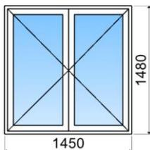
Menuiseries isolantes gamme « BOIS ALU » avec recouvrement (jeu de 12 mm), Capotage alu dual
