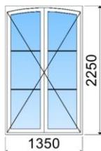
Menuiseries isolantes gamme « EURO » avec recouvrement (jeu de 12 mm), pièce d'appui et jet d'eau arrondis, portes fenêtre équipées d'un seuil aluminium surbaissé.
