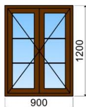
Menuiseries isolantes gamme « à l'Ancienne » sans recouvrement à noix et gueule de loup, pièce d'appui arrondie et jet d'eau arrondis, ferrages avec paumelles, crémone fonte RY en applique ou espagnolette, portes fenêtrée équipées d'une pièce d'appui bois.
