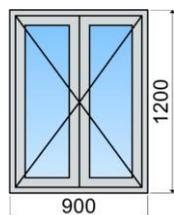
Menuiseries isolantes gamme « EURO » avec recouvrement, pièce d'appui et jet d'eau arrondis, portes fenêtrée équipées d'un seuil aluminium surbaissé, sans battement central, poignée centrée sur les menuiseries à 2-3-4 Vantaux avec crémone.
