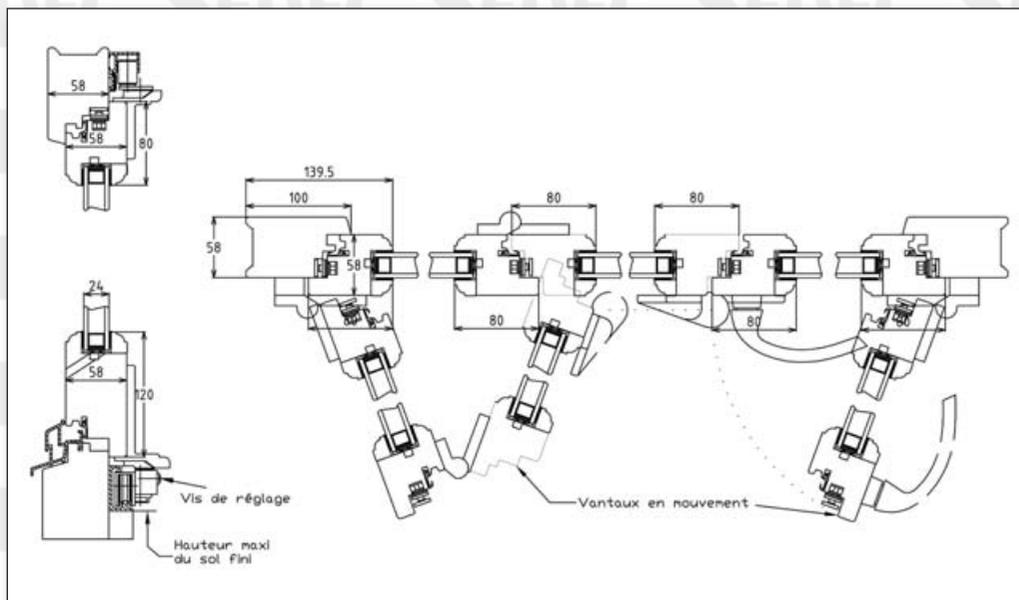
Fenêtre Repliable à Vtx, 58 mm, simple joint, GU922, profil 1/4 de rond.
