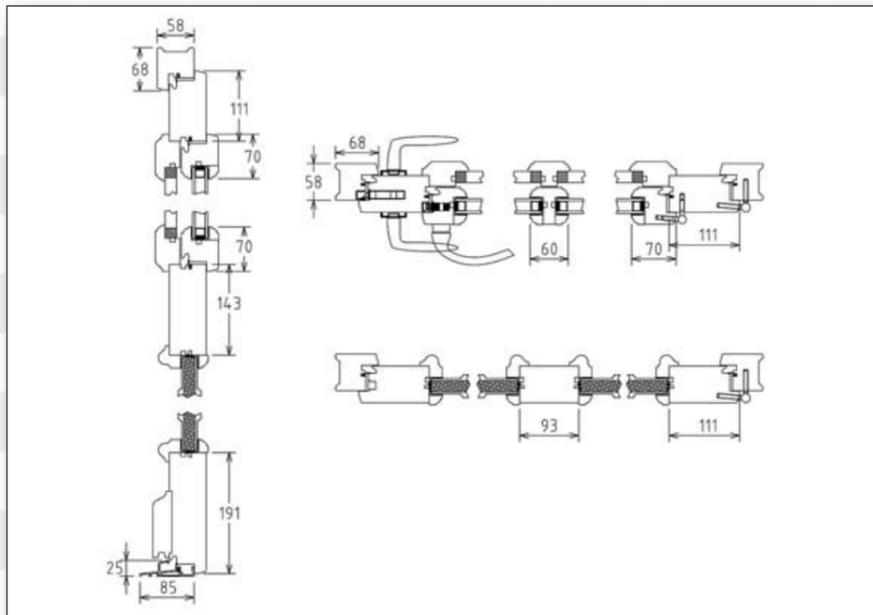
Porte d'entrée avec châssis à grille, 58 mm, simple joint, seuil alu, profil 1/4 de rond.
