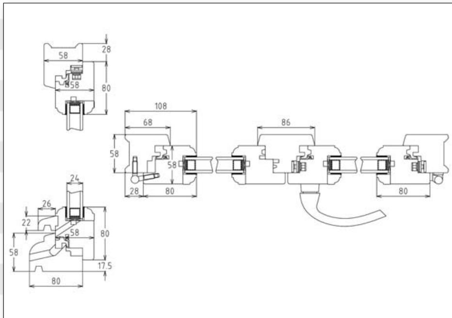
Fenêtre coulissante à translation à 2 Vtx, 58mm, simple joint, pièce d'appui 80mm, profil ¼ de rond.
